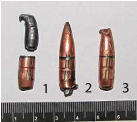
Рис. 7. Общий вид пуль после попадания в блок баллистического пластилина
