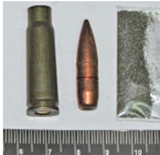
Рис. 2. Общий вид элементов снаряжения патрона
