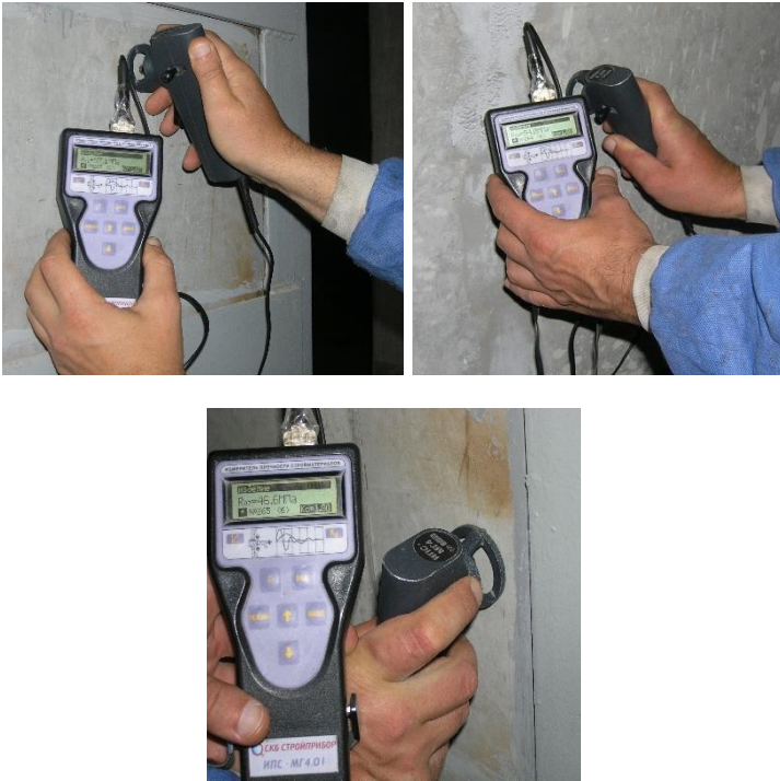
Рис. 2.15. Визначення параметрів міцності залізобетонних колон
