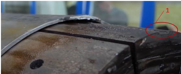
Рис. 2. Поздовжній паз робочого інструменту для розташування зварного шва: 1 – ширина 45 мм, глибина 5 мм
