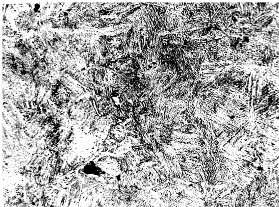
Рисунок 4.4 – Мікроструктура зони кручення після випробувань при 1250 °С та охолодження на повітрі сталі 18Х15Н3М-Ш (×800)
