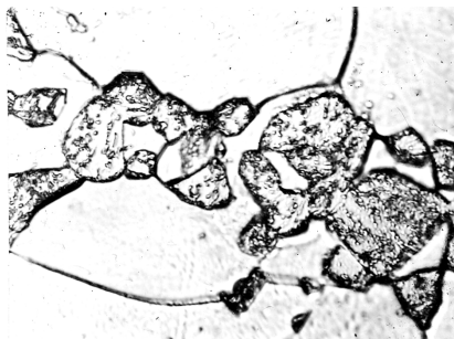
Рисунок 2.5 – Мікроструктура сталі 08X18ч після гарту 950 °С та витримки 3 хв
