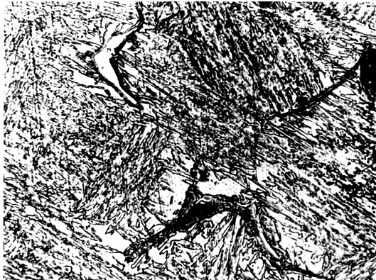
Рисунок 4.6 – Мікроструктура сталі 18X15N3M-III у литому стані ( \times 800 )
