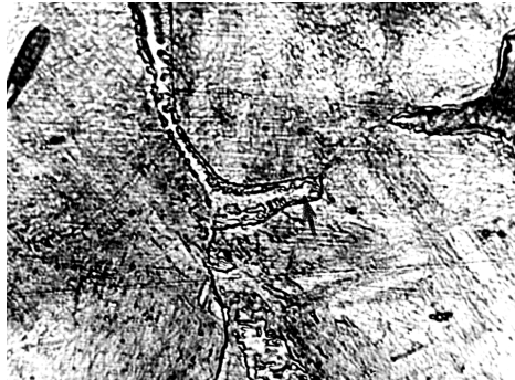
Рисунок 4.15 – Мікроструктура зразків сталі 18X15H3М-Ш, охолоджених від температури 1100 °С до 650 °С зі швидкістю 50 град./год, потім у воду (×800)
