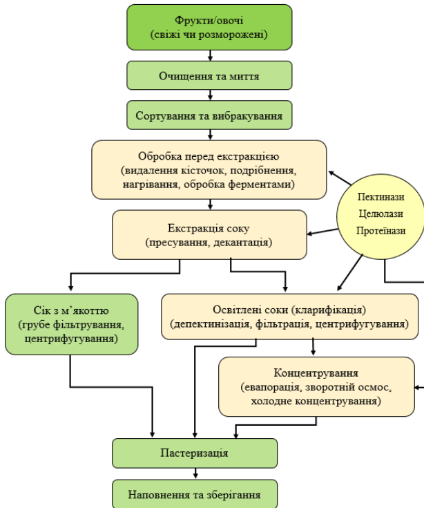
Рис. 1. Блок-схема технології виробництва натуральних соків
