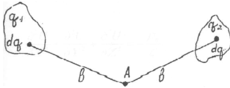
Рис. 2. Схема розподілу точкових зарядів dq в об'ємі V
