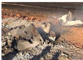
Рис. 1. На передньому плані (фото зліва) хвостовий відсік (рульові площини обламані, але видно отвори під приводи рулевих машинок), за ним – відокремлюваний обтічник
