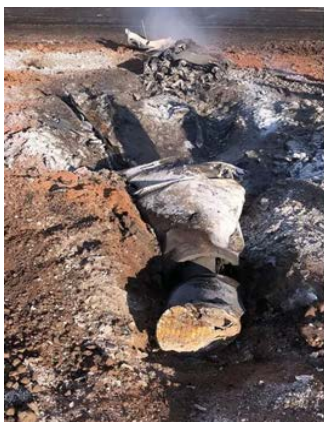
Рис. 3. На передньому плані (фото зліва) головний відсік з головкою самонаведення (далі – ГСН) (головний радіопрозорий обтічник зруйнований), за ним – корпус відсіку бойової частини (бойова частина відірвана і лежить окремо)
