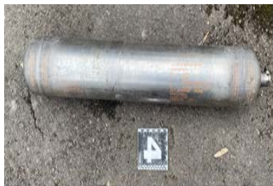
Рис. 14. Балон надування (06.0458.0090.00; 06.0458.0100.00; МР-1ГАЦ-1-24274; вага 5,935; об'єм 6,969; робочий тиск 350 атм; граничний тиск 525 атм)
