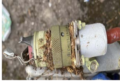
Рис. 13. З'єднувач низькочастотний циліндричний (СНЦ23-19/22P-6-8)
