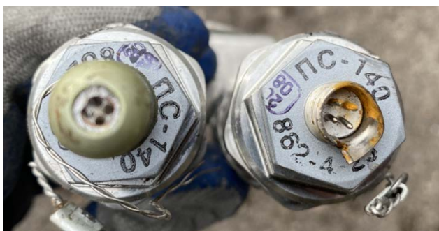
Рис. 17. Піротехнічні засоби розпалювання (ПС-140862-4-2)
