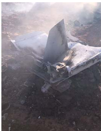
Рис. 4. Відокремлений обтічник з оперенням (фото справа – уламки лежать задом наперед)
