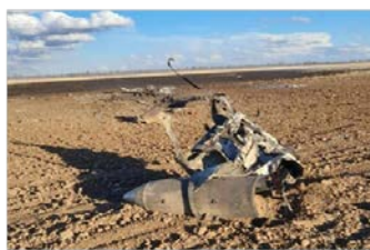
Рис. 2. На передньому плані (фото справа) відірвана з корпусу відсіку бойова частина проникаючого типу, за нею – уламки корпусу приладового відсіку
