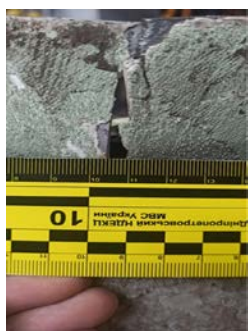
Рис. 6. Послаблений перетин шпангоуту кріплення головного обтічника до корпусу відсіку системи наведення (фото справа)
