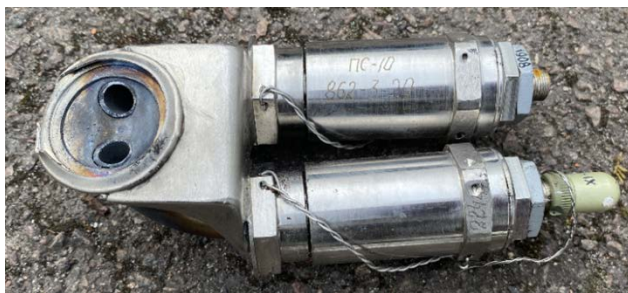
Рис. 16. Піротехнічні засоби розпалювання ППРД (ПС-10862-3-20)
