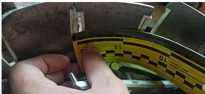
Рис. 8. Послаблений перетин шпангоуту кріплення головного обтічника до корпусу відсіку системи наведення
