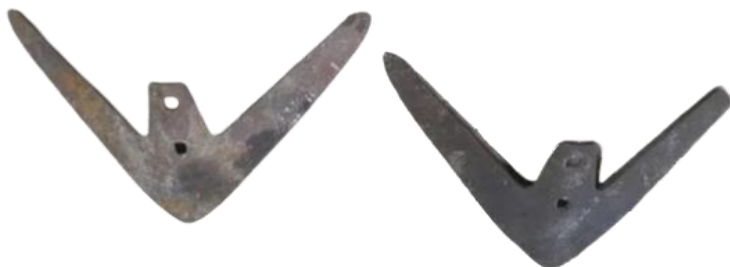
Рис. 1. Зношені лапи культиватора марки КПС-4
