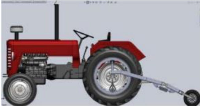
Рис. 2. Макетний зразок способу переміщення тягово-транспортної системи за допомогою поштовху колісного рушія в зоні його стиснення та осередку обертання
