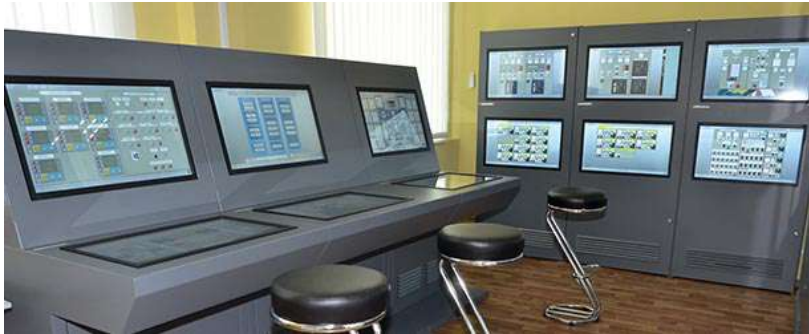
Рисунок 1 – Загальний вигляд центрального поста управління тренажера МВ фірми WARTSILA ERS 5000 TechSim
