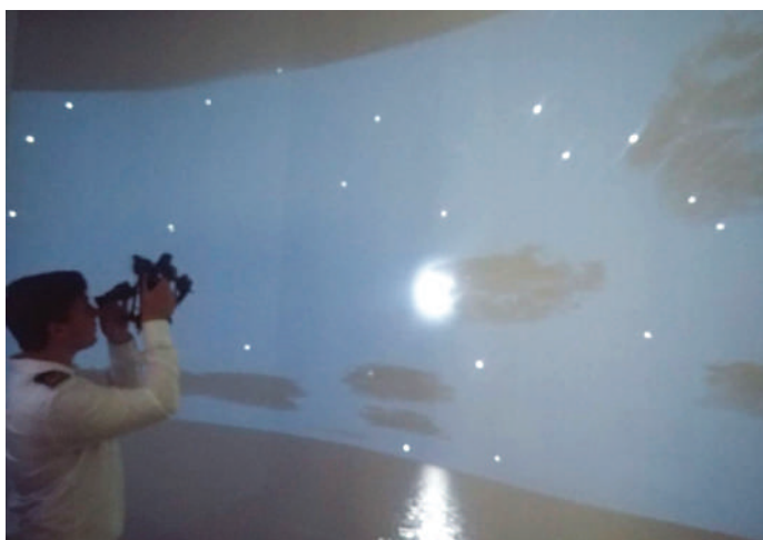
Рисунок 3 – Визначення висоти зірки секстаном на зоряному небі на навігаційному тренажері “Повномасштабний місток з візуалізацією TRANSAS NT PRO 5000”
