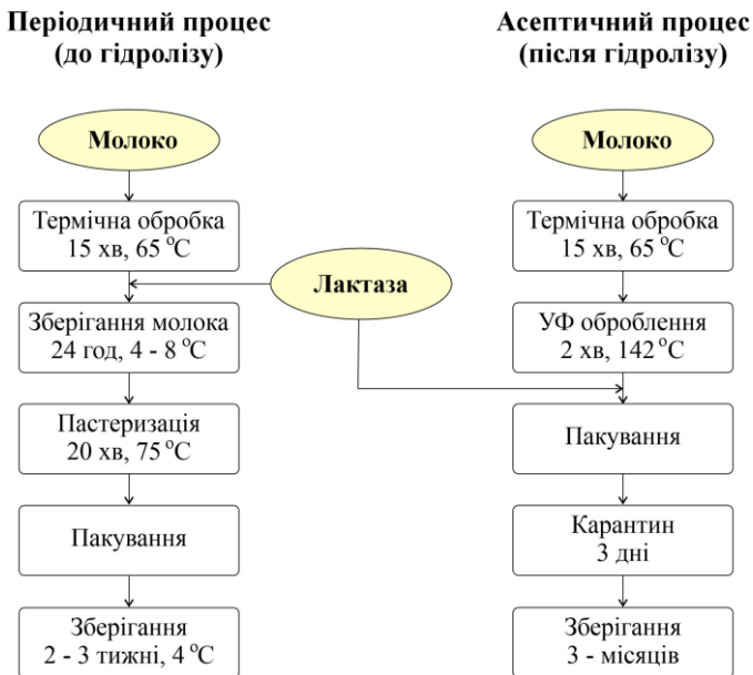
Рис. 1. Схематичне зображення періодичного (ліворуч) і асептичного (праворуч) процесів, які використовуються для виробництва молока без лактози
