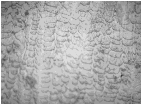
Рис. 2. Мікроструктура наплавленого металу (x400) – дрібнозернистий аустеніт
