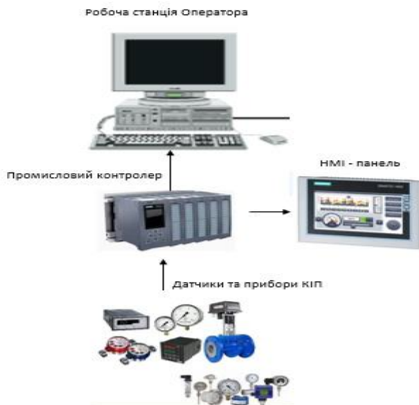
Рис. 2. Комплекс технічних засобів системи за рівнями
