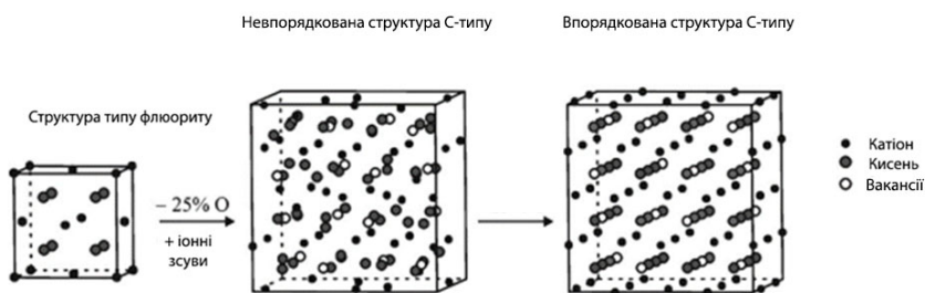
Рис. 4. Схема утворення впорядкованої структури С-типу [39]
