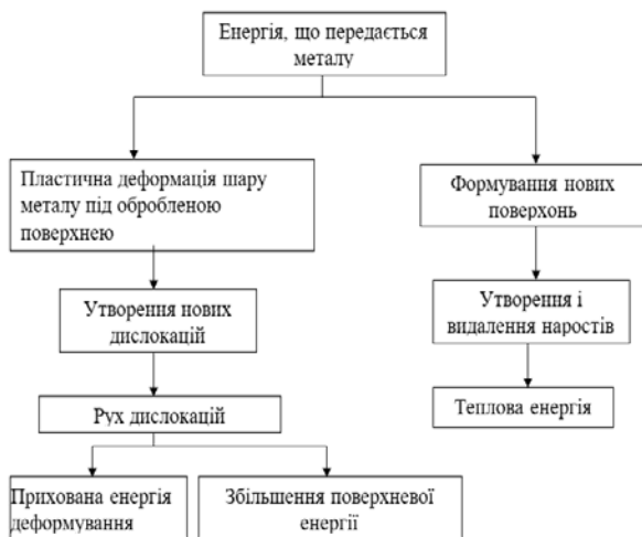
Рис. 1. Схема дислокаційно-енергетичної моделі розподілу енергії, що передається металу в процесі обробки металевою щіткою
