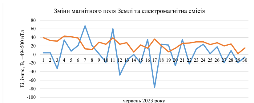
Рис. 5.5. Зміна магнітної індукції магнітного поля Землі (крива синього кольору), електромагнітна емісія в діапазоні 5 кГц (крива коричневого кольору). Червень 2023 року. РГС «Тросник»
