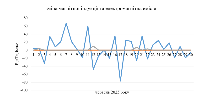
Рис. 5.3. Електромагнітна емісія в діапазоні 2 кГц (крива сірого кольору), зміни вектора магнітної індукції магнітного поля Землі (крива синього кольору). Закарпатський внутрішній прогин. Червень 2023 року
