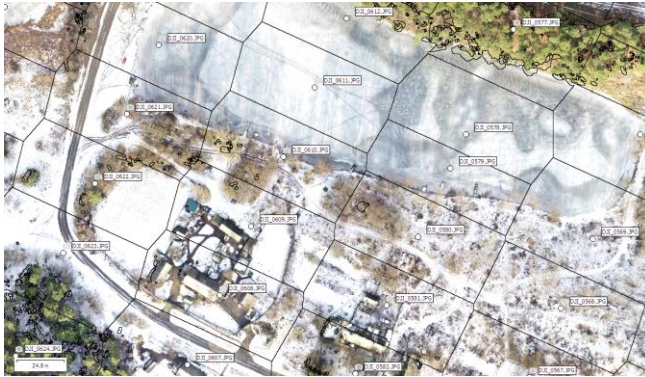
Рис. 18. Лінії порізів ортофотоплану
