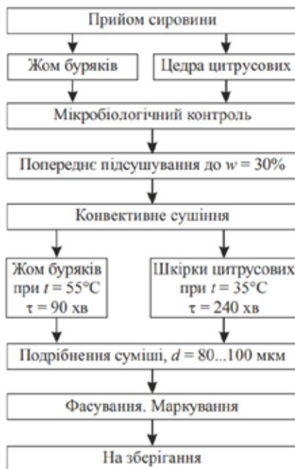
Рис. 1. Схема отримання композицій харчових волокон із жому цукрових буряків і цедри citrusових
