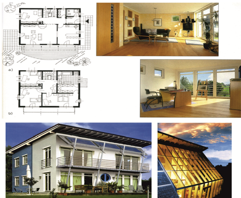
“Сонячний будинок” з регулюємими і фіксованими затінювачами. На головному фасаді південної орієнтації встановлені нижні і верхні фіксовані затінючі навіси; зверху затінюючий навіс оснащений 3-ма сонячними батареями, які нагрівають воду для побутових потреб: а) перший поверх, вид зверху; б) другий поверх, вид зверху.
