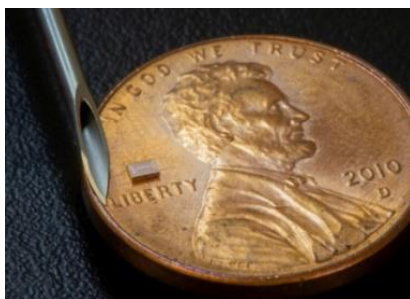
Рис. 1. Підшкірний сенсор розміром 0,85 \times 1,5 мм: а) на фоні одноцентової монети діаметром 19 мм; б) порівняно з ребром одноцентової монети товщиною 1,5 мм; в) порівняно з пенні та вістрям біопсійної голки розміром 16G (1,65 мм) 5
